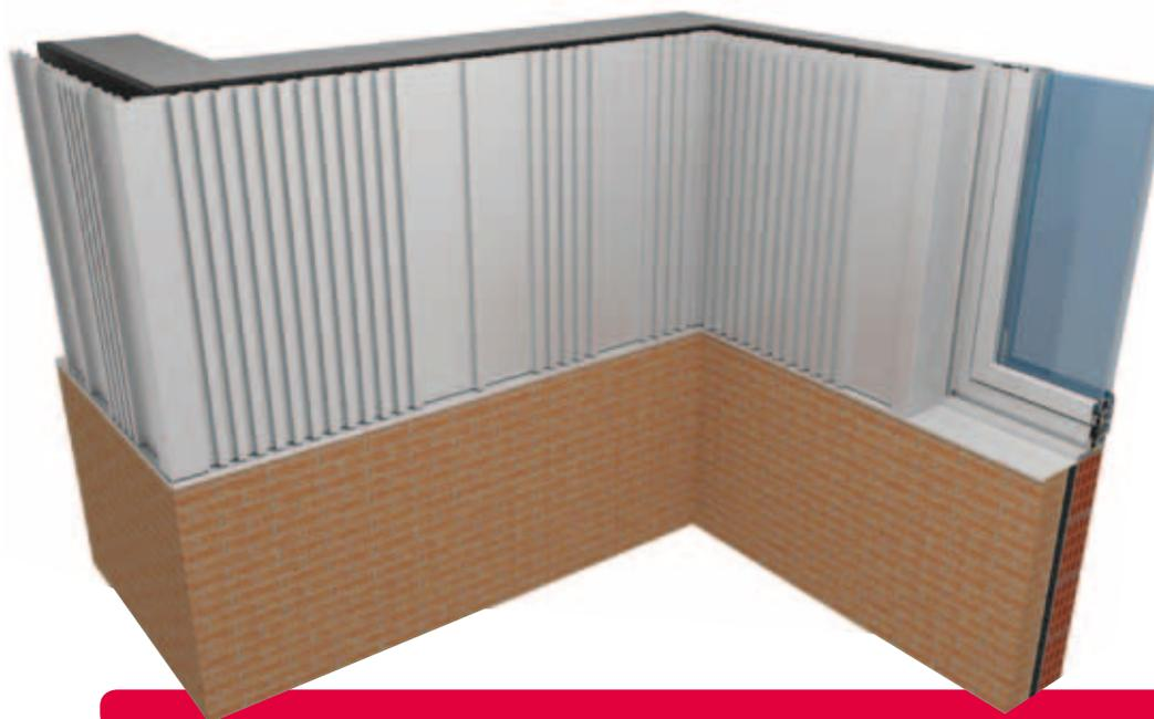
Ejemplo de montaje en exterior y remates realizados con ángulos, perfiles de inicio y chapa plegada
